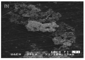
Fig.2. Imágenes de polvos de Ca<sub>0.3</sub>La<sub>0.7</sub>MnO<sub>3+δ</sub>. (a) del polvo sin tratamiento térmico, (b) del polvo con tratamiento térmico.
