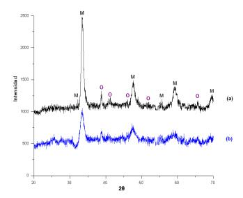
Fig.1. Patrones de difracción de rayos X de polvos de Ca<sub>0.3</sub>La<sub>0.7</sub>MnO<sub>3+δ</sub>. a) Difractograma del polvo con tratamiento térmico, b) Difractograma del polvo sin tratamiento térmico.
