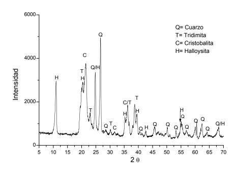
Figura 1. Difractograma de la cabeza de partículas entre -595 y +37 µm, a separar en la mesa concentradora.
