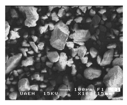
Figura 2. Imagen de Microscopía Electrónica de Barrido de las arenas de alimentación de la mesa concentradora.
