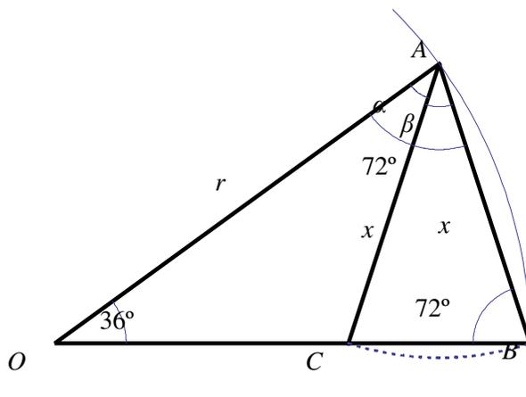
Figura 2: Construcción de un decágono regular.
