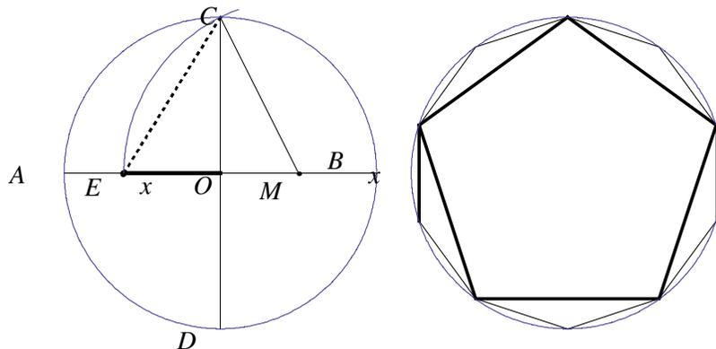
Figura 3: Construcción de un pentágono regular.
