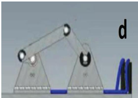
Figura 2. Simulación tridimensional de un mecanismo de Grashof.
